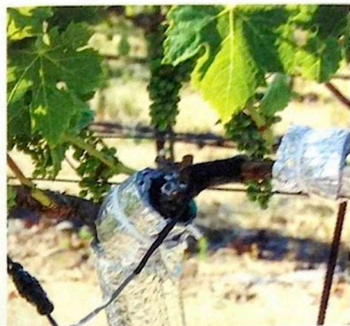
LES CAPTEURS CHAUFFENT LA PLANTE et mesurent la vitesse de déplacement de la chaleur pour calculer le flux de la sève.
